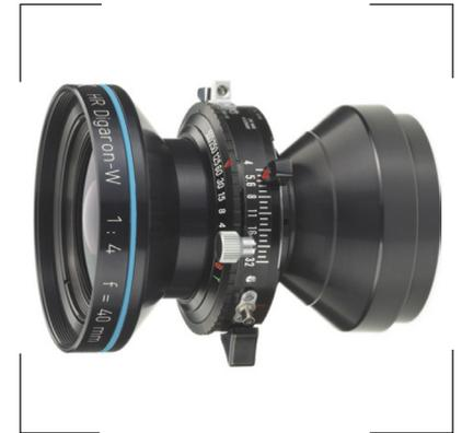
現時点ではこのシリーズとしては焦点距離40mm、70mm、90mmの3機種を揃えています(アポ・シロナーデジタル70mm F5.6と90mm F5.6の2機種は新しいコンセプトに合致したのでHRディガロンWと名称を変更しました)。MTFカーブが明確に示す通り、このシリーズのレンズは、さらに優れたHRディガロンSシリーズの高い基準に殆ど合致します。このシリーズにおいても、像面歪曲の徹底的補正と光学設計へのセンサーカバーガラスの統合という手法を用いて球面収差や色収差、非点収差を補正し、回折限定の高画質を実現しています。光学ガラスの特性に配慮したハイテクのマルチコートにより究極の透過率と優れたコントラストを実現すると共にゴーストやフレアーを防止します。
