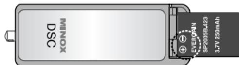
DSCカメラは"MINOX"のロゴ側に、バッテリーの極性表示面がくるように、挿入します。
