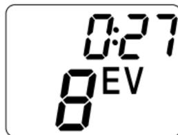
カウントダウンを止めるには「M」キーを押します。もう一度押すと再スタートします。タイマーは背景で動くので、露出計の他の測定機能は関係なく作動します。
