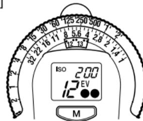
測定キー「M」を押してシャッター速度目盛りのダイヤルを回し、EV値変換表示窓の数字をディスプレイに表示された数値に合わせます。絞り値とシャッター速度が合ったところが適正露出値です。
