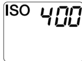
「露出測定」機能を選択し、OK信号が鳴るまで機能ボタンを押し続けます。ディスプレイ上では、EVではなくISOが点滅します。
