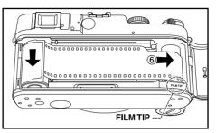
⑥パトローネを押さえながら、フィルムの 先端を[FILM TIP]マーク(緑のライン)ま で引き出し、スプールの上に乗せます。
