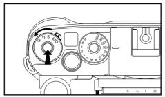
電源OFF解除ボタンを押しながら、モード ダイヤルレバーを"S" "C" "**心**" に合わせま す。 背面のモード表示部が表示されます。
