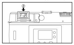
②視度調整レンズをファインダーアイピー ス取付けガイドに合わせ、カチッと音が するまでスライドさせて取付けます。
