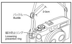
ストラップ取付け部にストラップの先端 を通し、緩み防止リング バックルの順に 通して取付けます。
