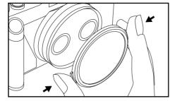
レンズキャップ左右の二ケ所のつまみを 内側に押しながら、レンズ先端のネジ部に 取付け、または取外します。
