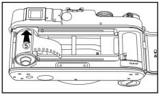
⑤図のようにパトローネを斜めにして、 フィルムを押し込むように入れます。
