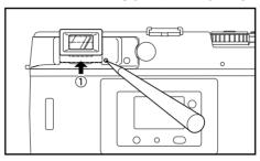
①ファインダーアイピースロック解除ボ タンを押しながら、ファインダーアイ ピース枠の下側の切り欠き部から上に ファインダーアイピースをスライドさ せ、取外します。
