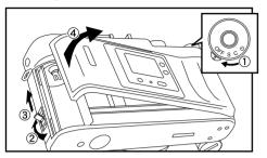
フィルム確認窓からフィルムが装填されていないことを確認します。
