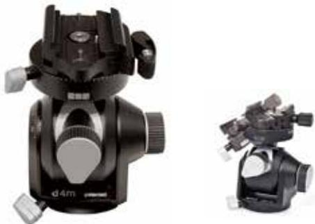
水平方向のティルト軸 (X 軸) と垂直方向のティルト軸 (Y 軸) の基本が同一で、カメラを回転させるパニングの中心軸も X 軸 Y 軸の基本の真上に位置しますのでカメラの動きを最小限に抑え、向きを精密に調整することができます。ティルト調整機構はすべて微調整ギアを動かすノブとロックフリーボタンを備えています。ロックフリーボタンの解除で、ボールヘッドのように自由にカメラの向きを変えられるので、撮影開始時に大まかなカメラの位置を決めた後、ギア微調整ティルトに切り替えて、精密なカメラ位置の微調整を行えます。
